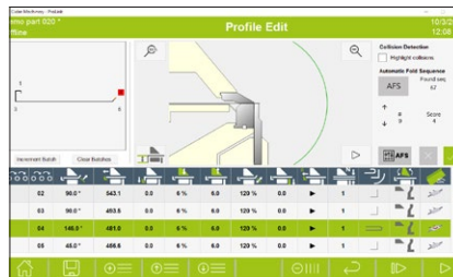
Diese Funktion berechnet automatisch die Biegereihenfolge, analysiert mögliche Kollisionen und zeigt diese für den Bediener grafisch an.
