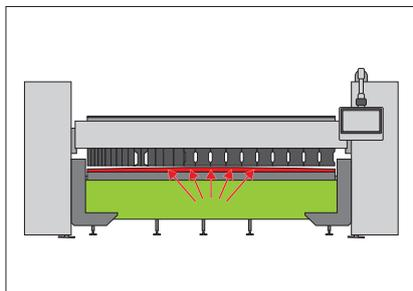
Die **Bombierung der Biegewange** sorgt für perfekte rechte Winkel und Maße entlang des gesamten Profils. Bei Z-Maschinen wird diese Funktion über die programmierten Werte gesteuert und die Einstellung erfolgt völlig automatisch.
