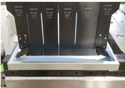
**Zusammenklappbare Eckwerkzeuge** (optional). Mit den einklappbaren Eckwerkzeugen ist es einfach, Teile mit nach innen gerichteten Flanschen aus der Maschine zu entfernen.
