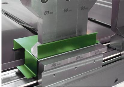
**Multifold** ist Standard für alle Z-Maschinen, d.h. alle Werkzeuge sind segmentiert. In Kombination mit dem höhenverstellbaren Anschlag bietet Multifold unübertroffene Flexibilität für die Profilgeometrie.
