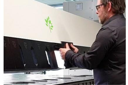
In der **Werkzeugwechselposition** erfolgt der Wechsel schnell und sicher. Das Kontrollsystem bestätigt, dass das richtige Werkzeug gewählt und korrekt montiert ist.
