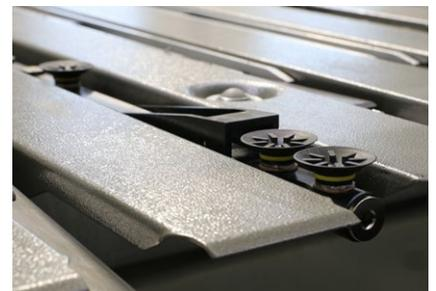
Mit den **Vakuumbreifen** im Hinteranschlag können Sie Details mit weniger Unterstützung durch den Bediener und mit größerer Präzision biegen. Dadurch verkürzen sich auch die Durchlaufzeiten.
