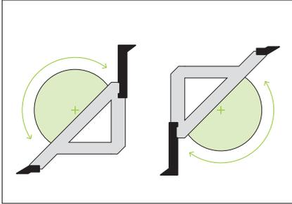
Mit der **Kombi-Oberwange** haben Sie den Vorteil einer geraden Schiene mit abgewinkelter Oberwange und hohen segmentierten Geißfußwerkzeuge mit demselben Werkzeugsatz. Mit dieser einzigartigen Drehlösung dauert der Werkzeugwechsel weniger als 10 Sekunden.
