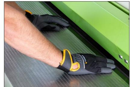
Die Positionierung des Niederhalters in lediglich 32 mm Entfernung von der Schnittkante bedeutet minimalen Verschnitt.
