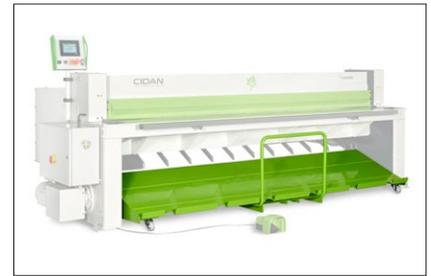
Mit einem Wagen als Alternative zum festen Rücklaufblech können Sie die Zuschnitte leicht durch die Werkstatt transportieren. Heben Sie den Wagen (lädt bis zu 400 kg Blech) mit einem Gabelstapler, um den Rücken zu schonen.
