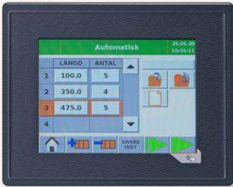
Mit CutLink im Automatikmodus können Sie 10 Zeilen mit Anschlagmaßen und der nacheinander ausgeführten Anzahl programmieren. Die Einstellungen werden im Systemspeicher abgelegt.
