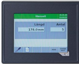
Mit CutLink im manuellen Modus stellen Sie die Anschlagmaße und die Anzahl ein. Im Menü „Quick Setup“ regeln Sie den Hochhalter, den Niederhalter und die Schnittreihenfolge.
