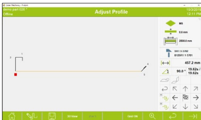
Sie zeichnen das Profil, berechnen die Maße, bestimmen die fertigen Winkel und geben die gewünschten Werte für eine Radiusbiegung an.
