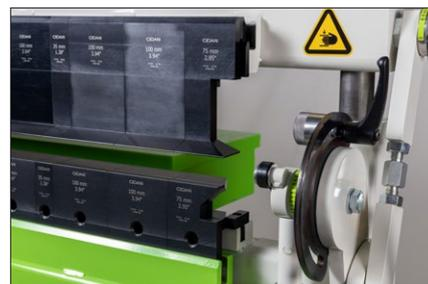
Eckwerkzeuge standardmäßig für maximale Flexibilität. Die Werkzeughöhe in der Unterwange beträgt 60 mm und die Werkzeuge in der Biegewange ist 94 mm.
