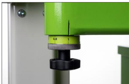
Passen Sie die Blechdicke bei Bedarf im Handumdrehen an, um ein perfektes Ergebnis zu erzielen.
