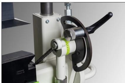
Einfache Einstellung des Biegewinkels mit dem Biegewinkelanschlag.
