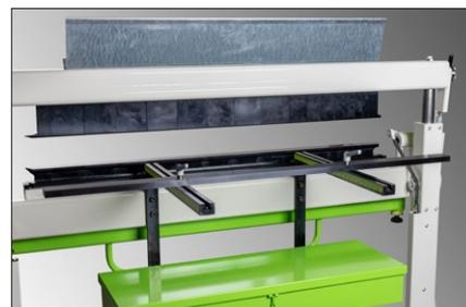
Der T-Nuten-Hinteranschlag ermöglicht flexible Einstellungen und große Wiederholgenauigkeit. Max Arbeitstiefe von 585 mm.
